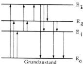
Zerlegt man das Licht verschiedener Lichtquellen mittels Prisma oder Gitter, so erhält man Emissionsspektren.
